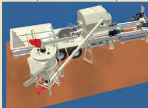
sistema de recolección de finos con silo de 1m 3
